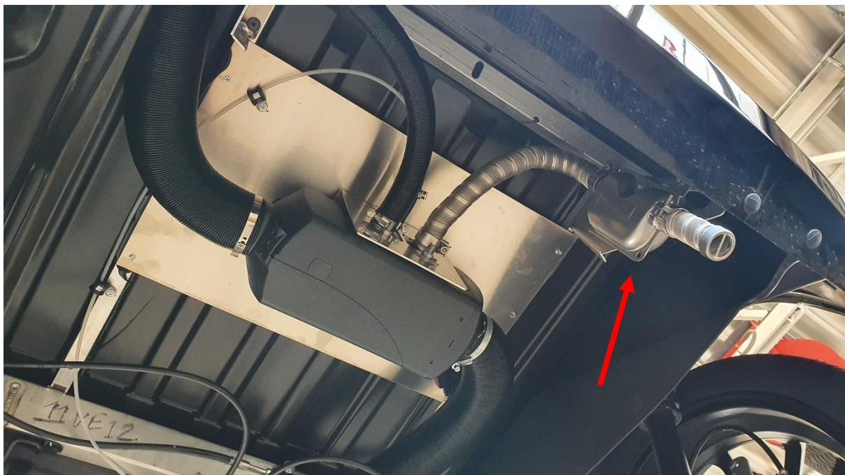
7. Nå monteres lyddemperen(Grått rør til høyre) fast på ønsket punkt slik at eksosen lett kan føres til friluft. Deretter klippes eksosrøret til riktig lengde og monteres på lyddemperen og varmer.
