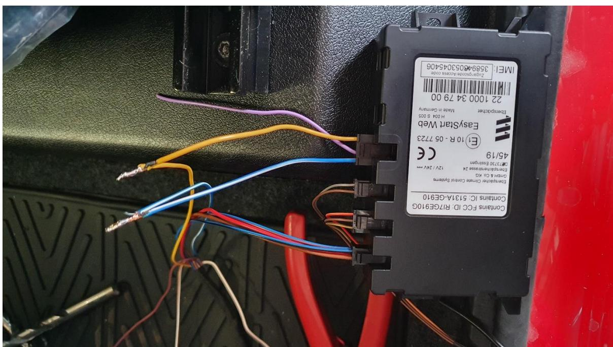
13. Trekk ledningene inn i kupeen via gummpakningene i torpedoveggen. Ledningene skjøtes sammen for enten ved loddning eller vanlig skjøtemuffer. Følg de samme fargekodene (Rød på rød, gul på gul etc).
