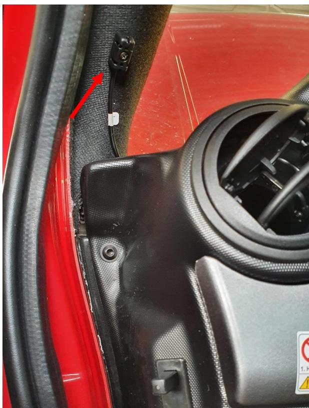
15. Borr deretter et hull på toppen av dashbordet hvor temperaturføleren trekkes igjennom og monteres som vist på bildet over. Her skrus den fast i A-stolpen.
